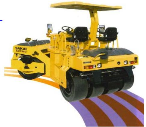
*\* En caso de la máquina con la tracción exclusivamente por ruedas traseras, tiene que comenzar compactación por las ruedas de tracción para evitar empujar mezcla. Cuando las ruedas empujan la mezcla, hay chance de crear las micro-grietas en pavimento.*
